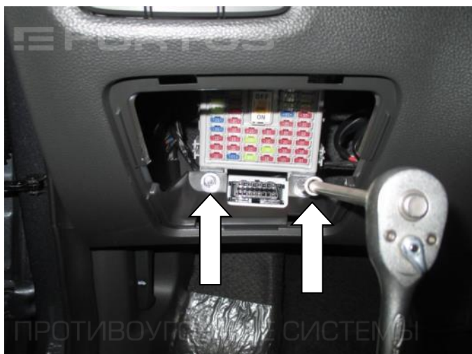
1. Снимите накладку консоли и открутите два болта крепления блока предохранителей
