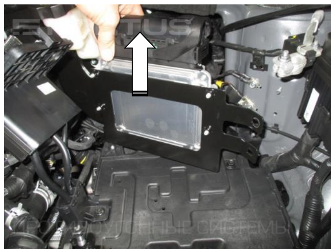
16. Снимите ЭБУ вместе с кронштейном
