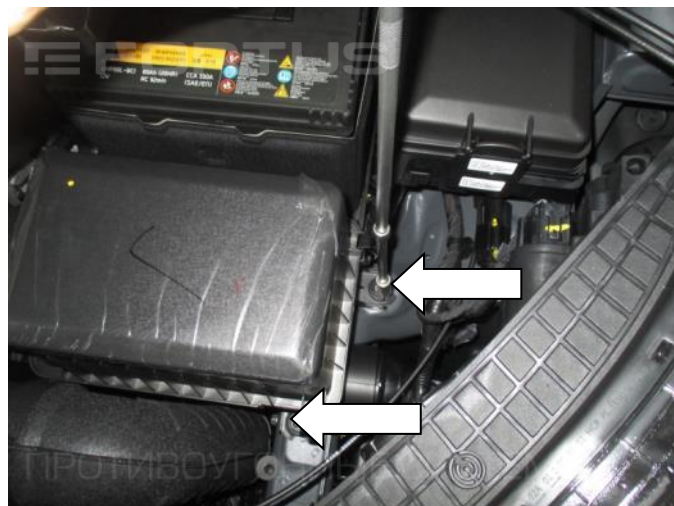
8. Открутите два болта крепления корпуса воздушного фильтра
