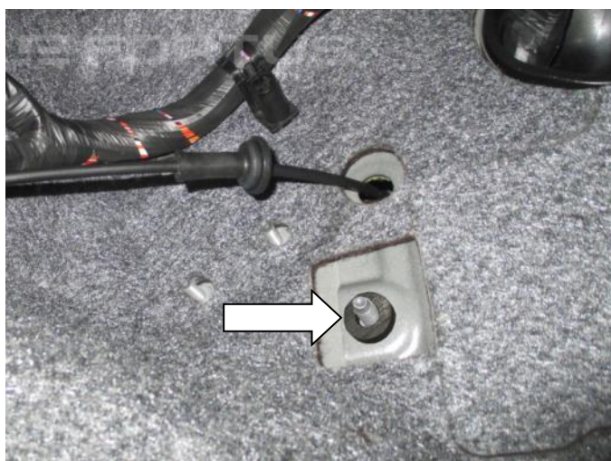
5. Установите проставку (поз. 10а) на штатную шпильку
