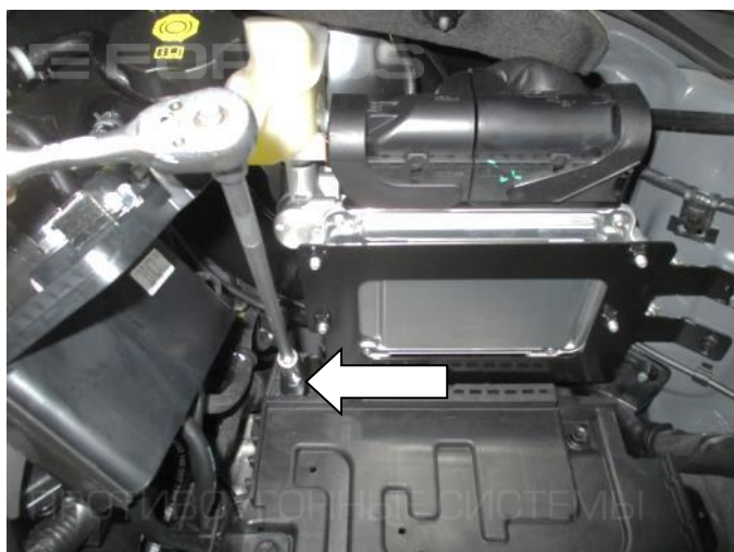
15. Открутите болт крепления кронштейна ЭБУ
