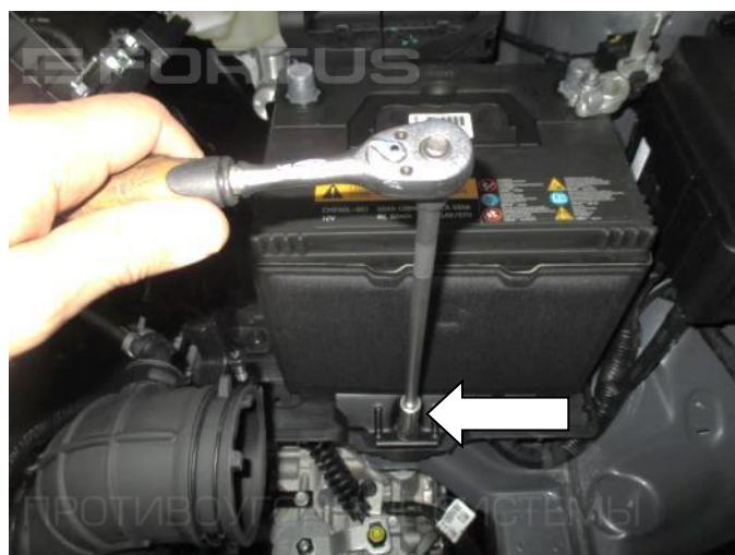
12. Открутите болт крепления кронштейна аккумулятора. Снимите кронштейн аккумулятора
