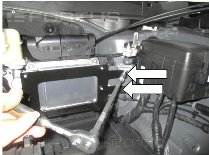
14. Открутите два болта крепления кронштейна ЭБУ
