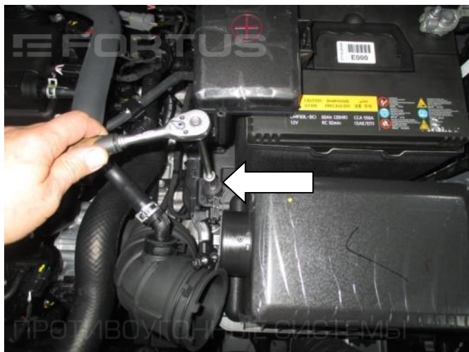
7. Открутите болт крепления корпуса воздушного фильтра
