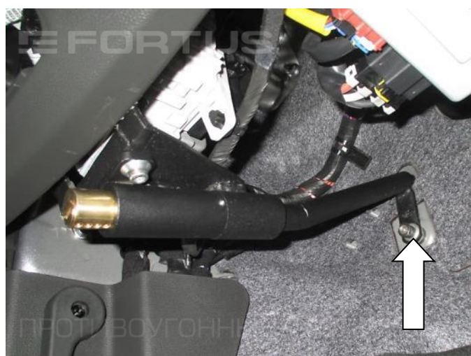
18. Установите замок (поз. 1) с кронштейном (поз. 1а) и закрепите переднюю точку крепления гайкой (поз. 15а) с шайбой (поз. 17а)
