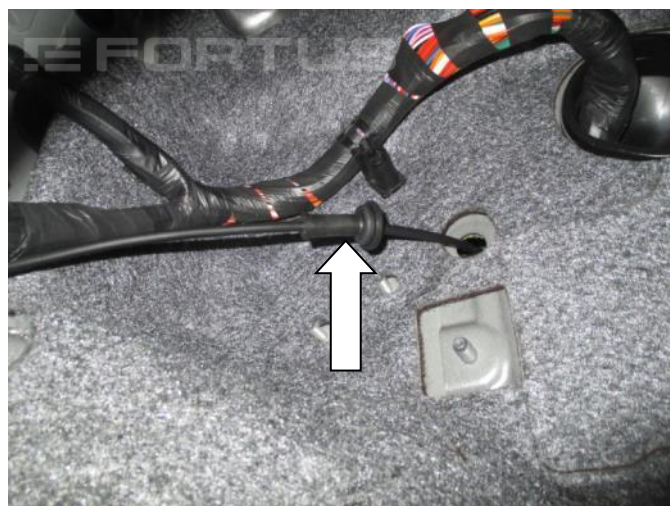
2. Снимите пыльник троса штатного замка капота
