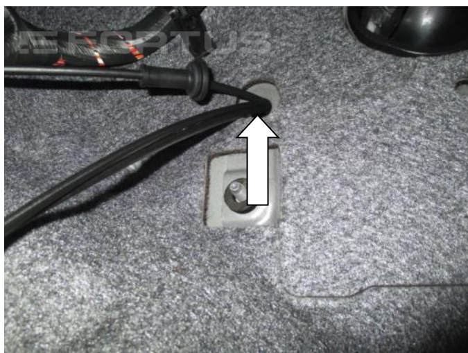
17. Со стороны салона автомобиля пропустите два троса замка (поз. 1) в штатное отверстие
