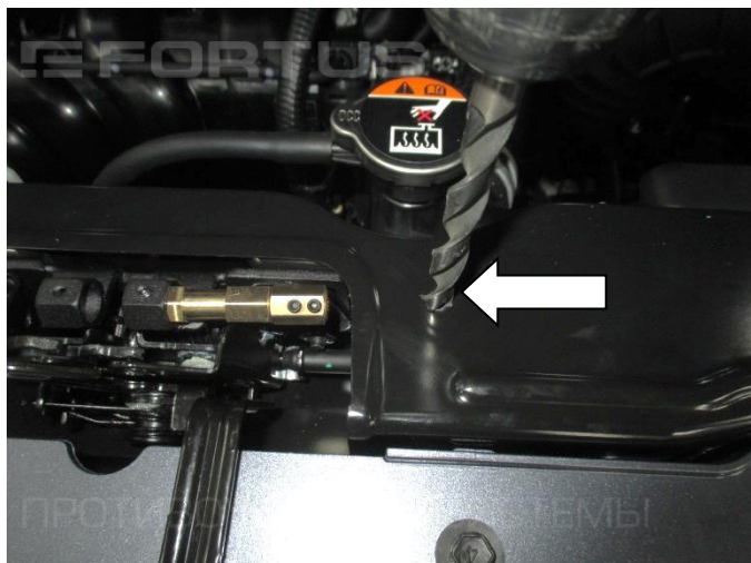
43. Просверлите отверстие \varnothing 8 мм в штатном кронштейне
