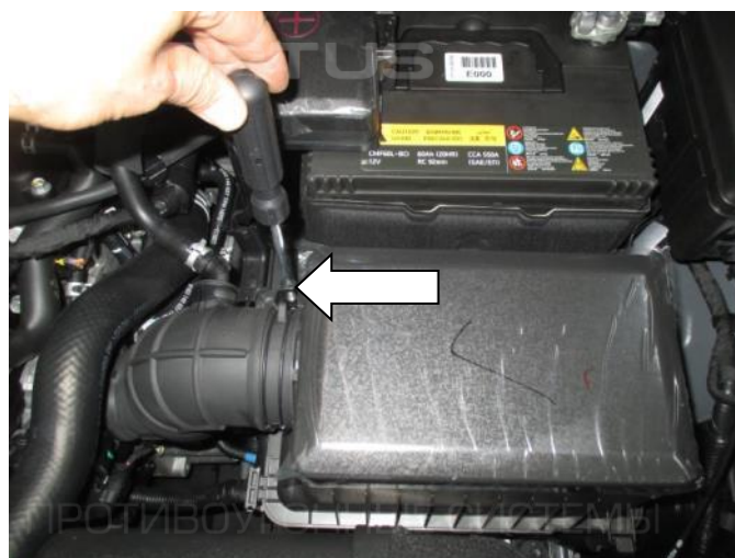
6. Открутите болт крепления хомута патрубка воздушного фильтра. Отсоедините патрубок воздушного фильтра
